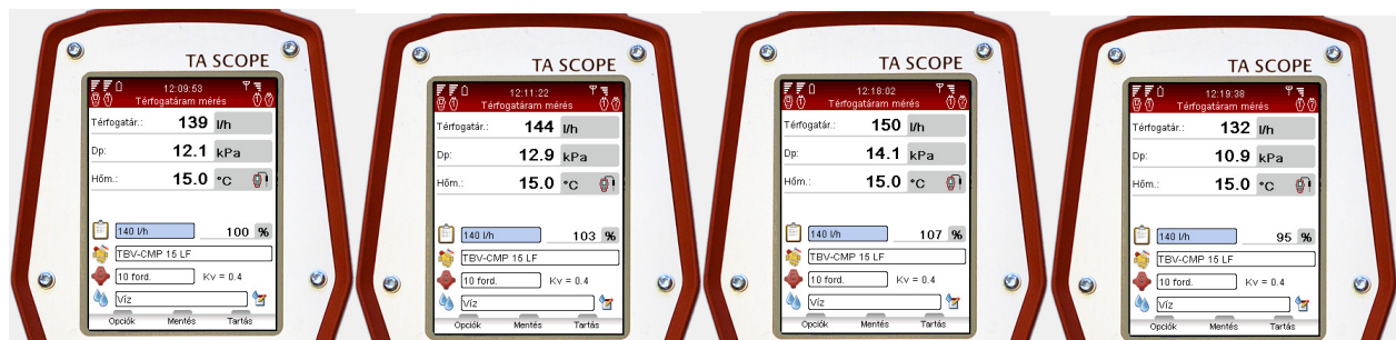
2. ábra: A stabilizált „Dp” változása (forrás: TA Hydronics)
