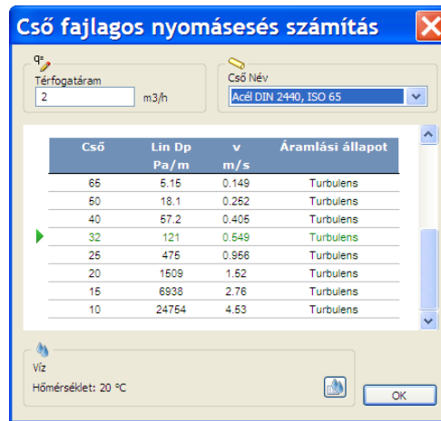
1. ábra: csővezetékek fajlagos nyomásesése (forrás: TA Select 4)
