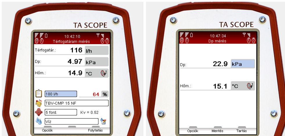
2. ábra: Hibadiagnosztika TBV-CMP dinamikus, automata beszállító szelepen (forrás: TA SCOPE szimulátor)
